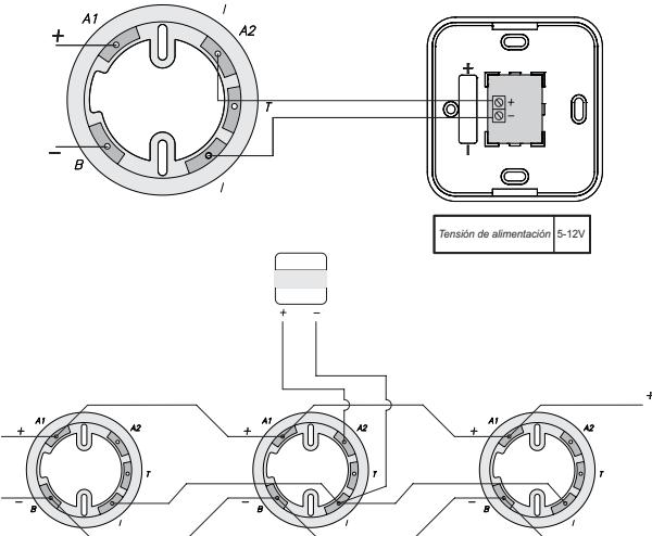
Esquema de conexionado sistema analógico
